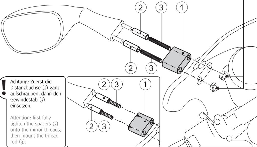
**! Achtung: Zuerst die Distanzbuchse (2) ganz aufschrauben, dann den Gewindestab (3) einsetzen.**
