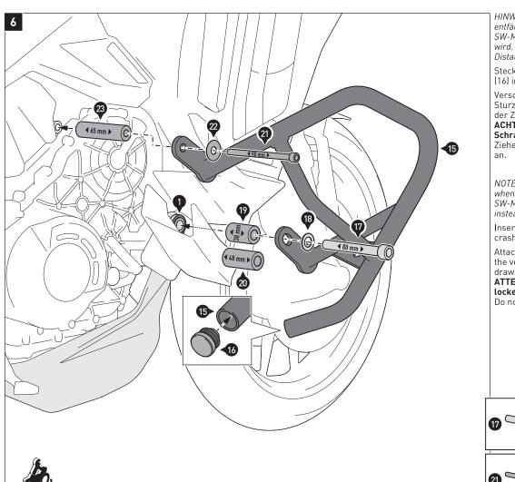
HINWEIS: Die Distanzbuchse (19) entfällt, wenn der Sturzbügel mit dem SW-MOTECH-Motorschutz montiert wird. Verwenden Sie stattdessen die Distanzbuchse (20).
