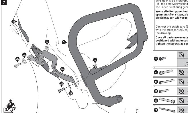
Verbinden Sie die Sturzbügel (3) und (15) mit dem Querverbinder (24), wie in der Zeichnung gezeigt.
