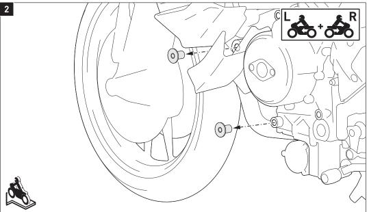
Entfernen Sie **beidseitig** die original Gewindeeinsätze vom oberen Anbaupunkt aus dem Fahrzeugrahmen.
