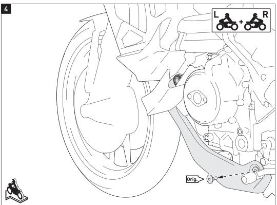
Montieren Sie den original Motorschutz an den **hinteren** beiden Anbaupunkten mit den original Schrauben (Orig.) wieder am Fahrzeug.
