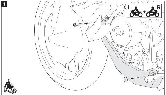
Lösen Sie **beidseitig** die gezeigten Schrauben des original Motorschutzes
